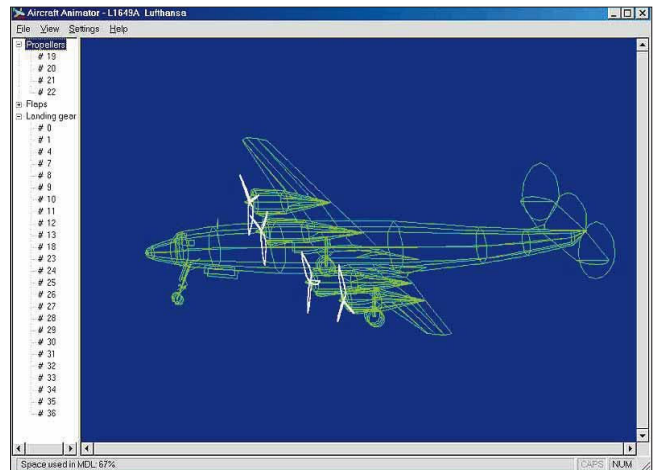
Aircraft Animator: Am skalierbaren Drahtgittermodell des Flugzeuges lassen sich die „Moving Parts“ bis ins Detail modifizieren.
