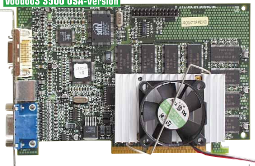
Für Übertaktungsvorhaben unumgänglich: Ein direkt an Chip oder Passivkühler angeklebter Lüfter. Die echte V3 hat keinen Lüfter.
