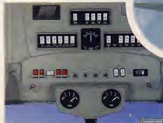
▲ Le panneau supérieur avec les cantrâtes d'allumage des moteurs et des pompes à carburant.
